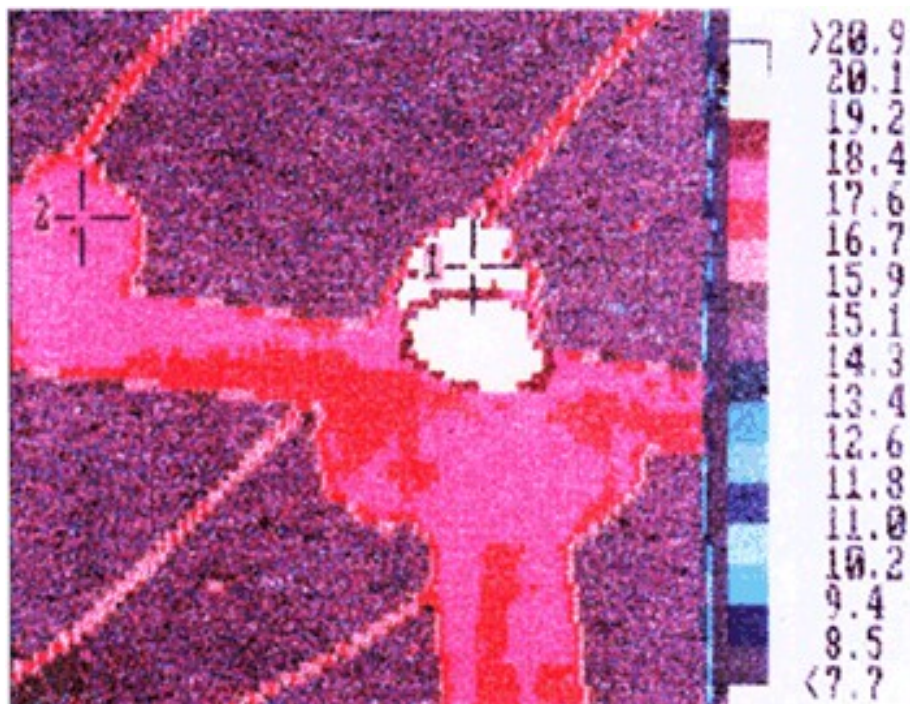
Шинный мост 6 кВ со штыревыми изоляторами:
