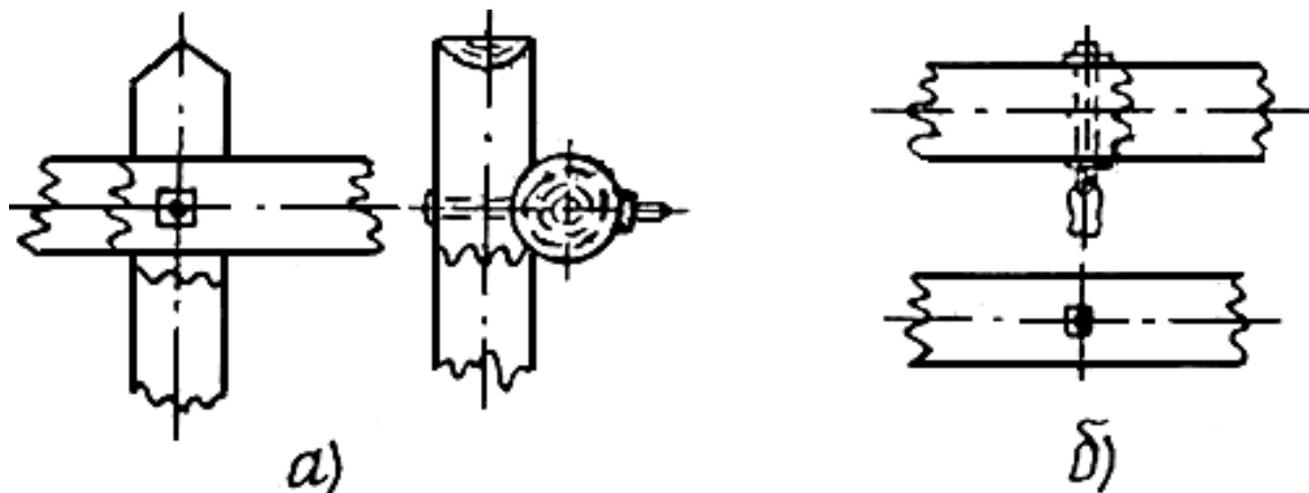
Рис.5.1. Устройство шунтирующего бандажа:
