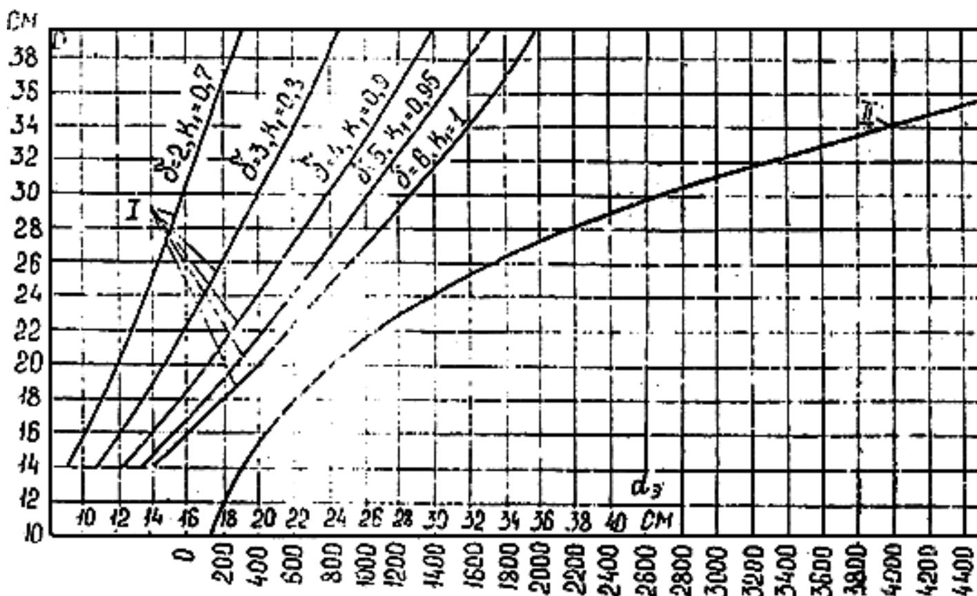
Рис.П7.2. Кривые зависимости эквивалентных диаметров и моментов сопротивлений
