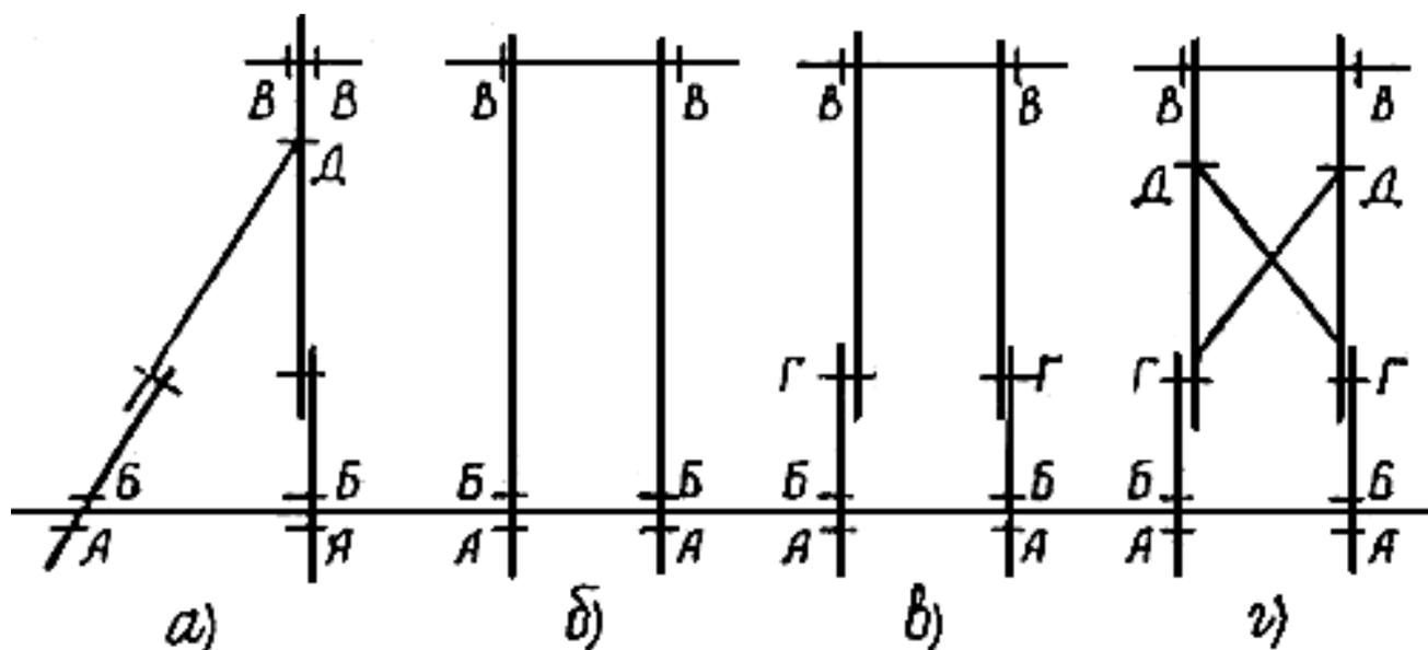
Рис.3.1. Опасные сечения деревянных опор:
