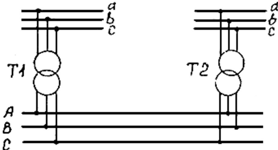
Рис.5.5. Схема плавки гололеда с встречным включением фаз трансформаторов перераспределения нагрузок в сети путем повышения токовой нагрузки обогреваемой линии;
