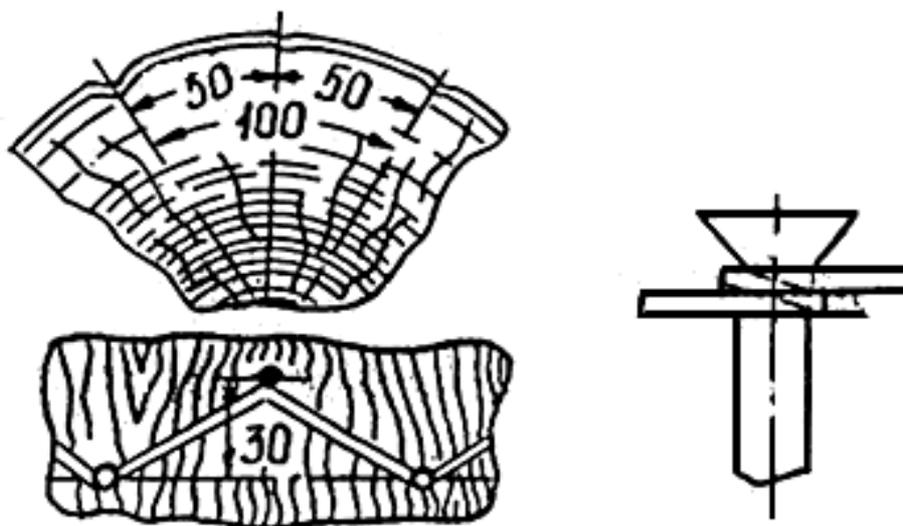
Рис.5.2. Закрепление шунтирующего бандажа гвоздями
