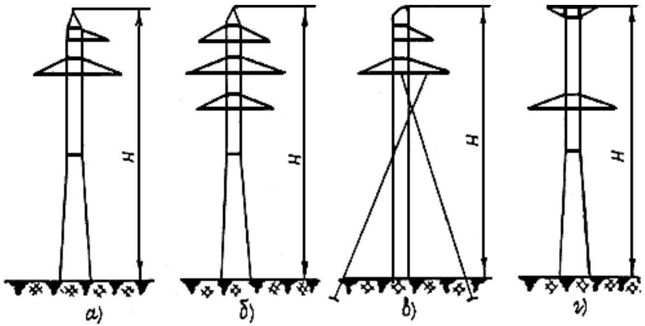
Рис.П8.4. Схемы металлических опор 35-330 кВ:
