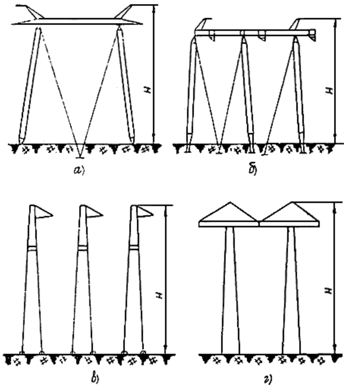
Рис.П8.6. Схемы металлических опор 500-750 кВ:
