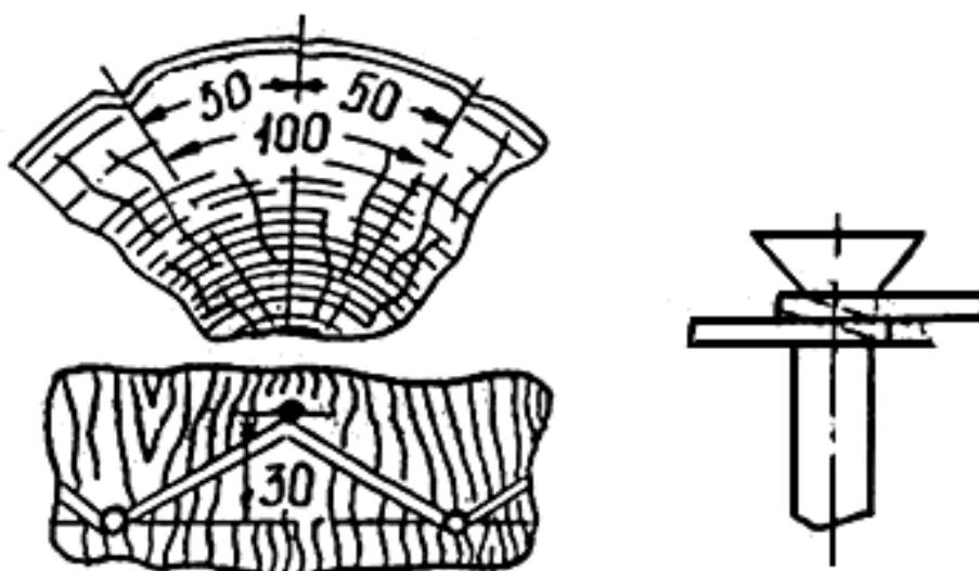
Рис.5.2. Закрепление шунтирующего бандажа гвоздями
