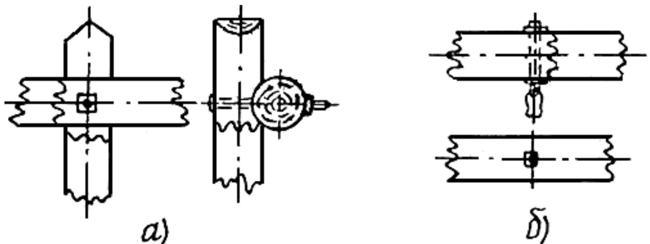
Рис.5.1. Устройство шунтирующего бандажа:
