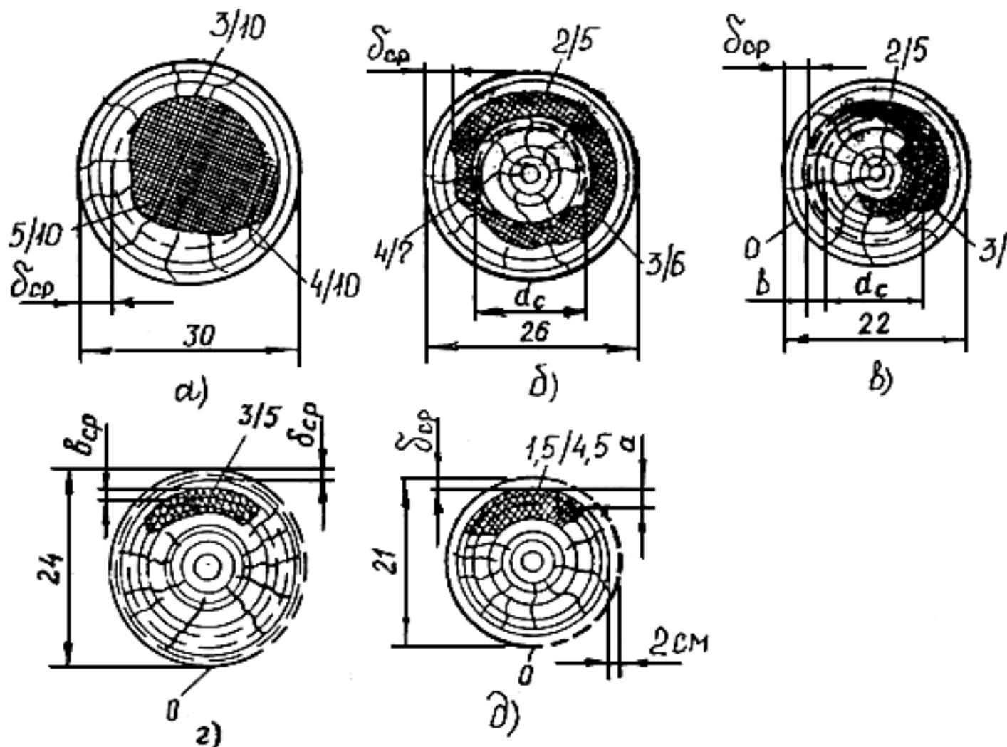
Рис.П7.3. Примеры внутреннего загнивания древесины:
