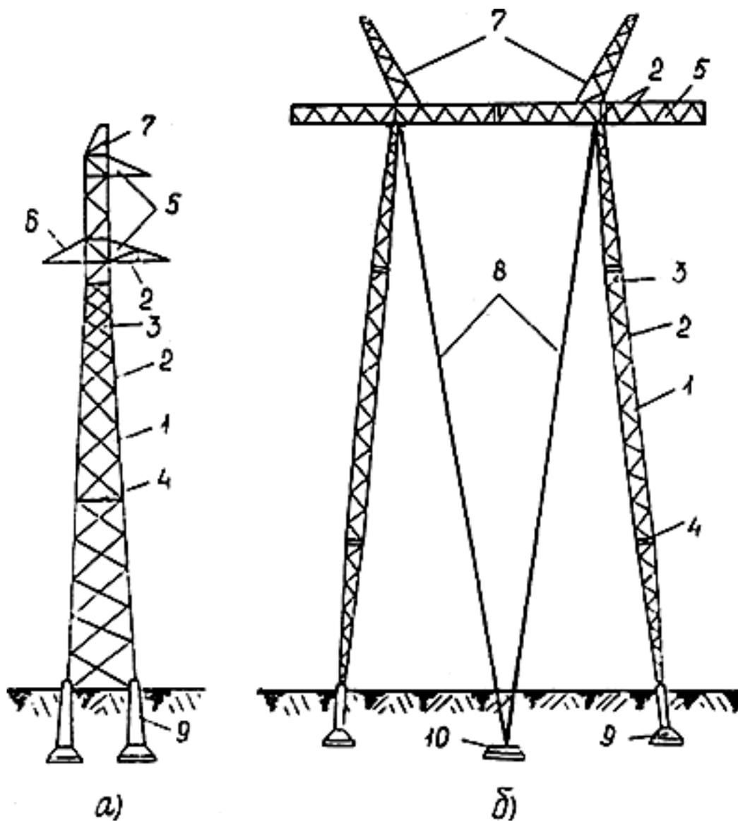
Рис.П8.3. Детали металлических опор и их элементы:
