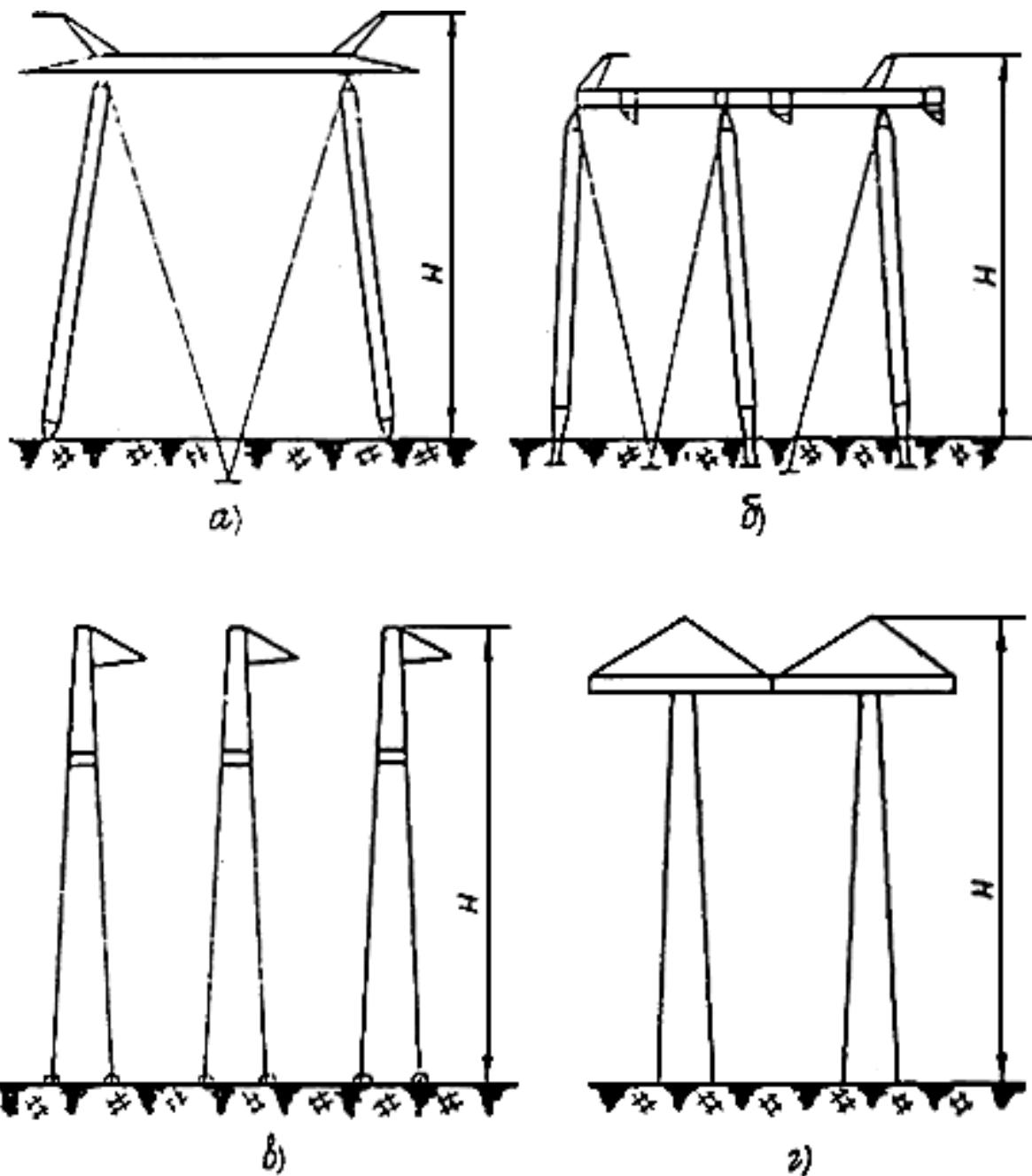
Рис.П8.6. Схемы металлических опор 500-750 кВ:
