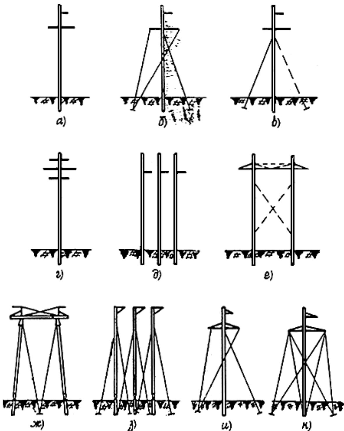
Рис.П8.2. Схемы железобетонных опор 35-500 кВ:
