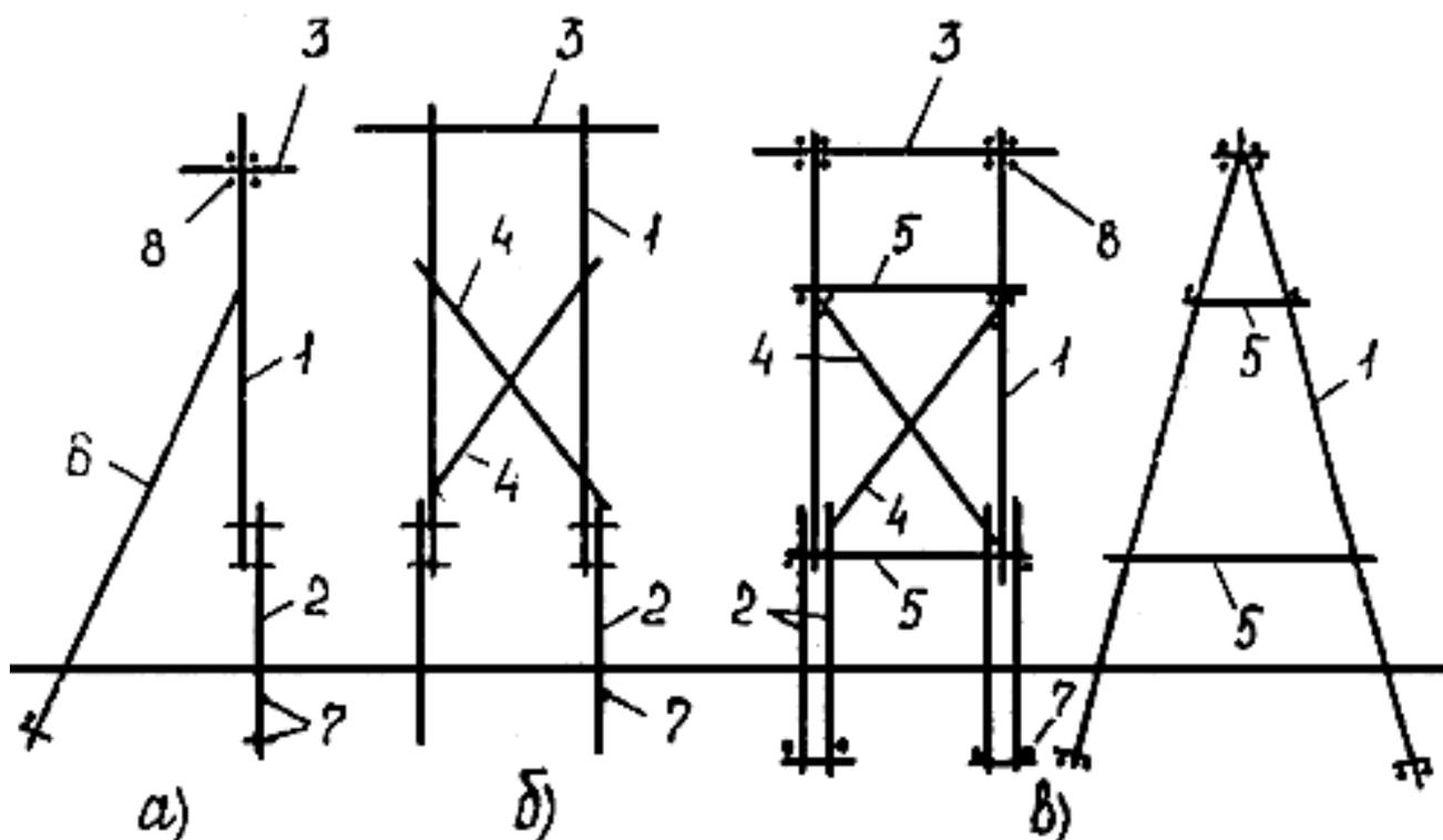
Рис.П8.7. Схемы деревянных опор ВЛ 35-220 кВ и их детали:
