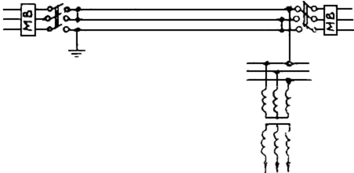
Рис.5.4. Схема плавки гололеда с последовательным соединением проводов фаз линии встречного включения фаз трансформаторов (рис.5.5);
