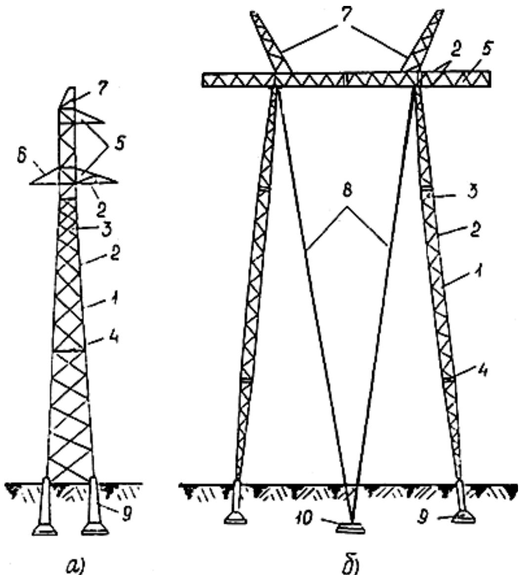
Рис.П8.3. Детали металлических опор и их элементы:
