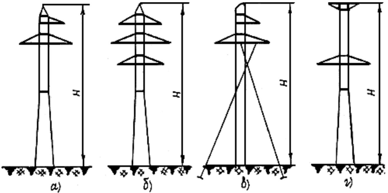
Рис.П8.4. Схемы металлических опор 35-330 кВ:
