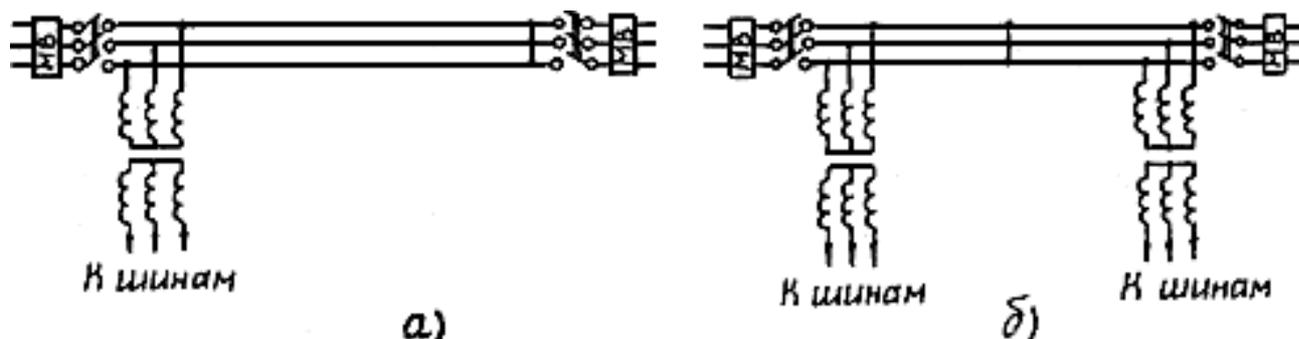
Рис.5.3. Схемы плавки гололеда с замыканием трех фаз:
